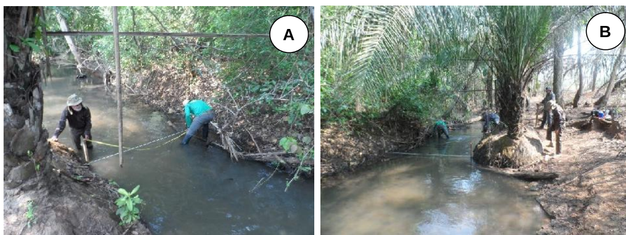
Figura 5. Demonstração do método do flutuador em um trecho do rio (garrafa ou rolha com objeto flutuador)
